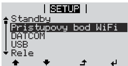
Příklad: Položka nabídky „Přístupový bod WLAN“
