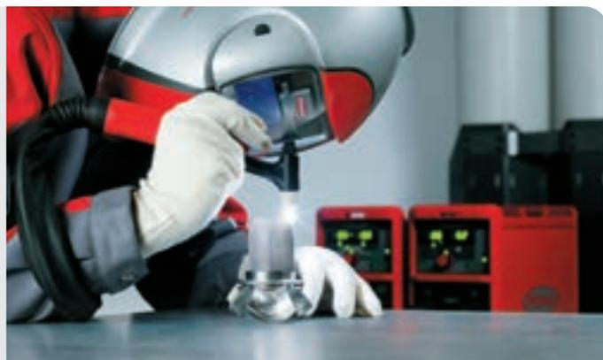
/ Manuelles Mikroplasma-Schweißen für Blechdicken ab 0,1 mm.
