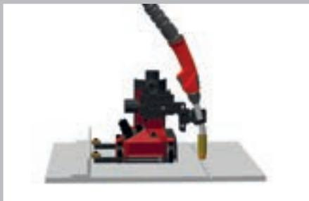
/ Réalisation de soudures bout à bout sur des composants horizontaux
