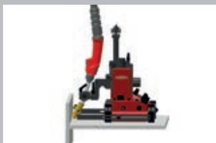
/ Réalisation de soudures d'angle sur des composants horizontaux
