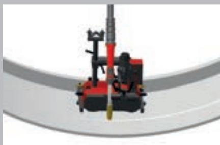
/ Réalisation de soudures bout à bout sur des composants concaves
