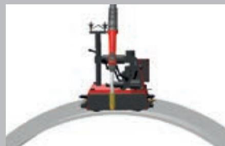
/ Réalisation de soudures bout à bout sur des composants convexes
