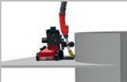
/ Réalisation de soudures d'angle sur des composants convexes
